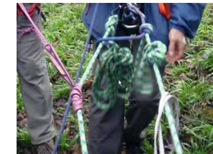
仮固定解除。マリナーヒッチのスリングはそのまま。後で回収。
