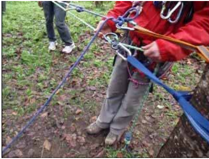
テンションを掛けたら下は緩むので結び目通過を行う。
