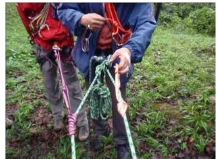
クレームハイトをセットしてマリナーヒッチ用に細くて長いスリングとカラビナを用意する。
