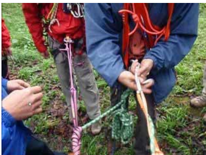
マリナーヒッチ ピナにスリングを巻き付けてスリング自身にグルグル巻いて最後にスリングの間を通す
